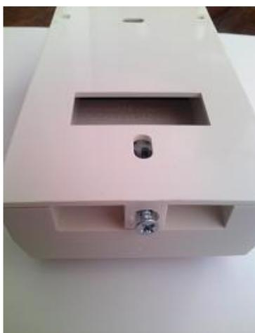
裏ぶたを取る為に下に付いているネジを回してふたの固定を解除する
